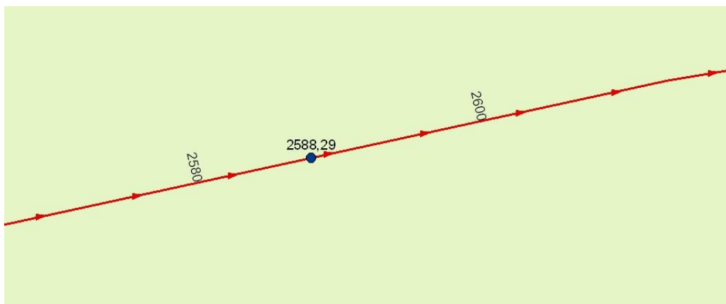
Bild 6. Ett punktformigt hållplatssegment på läget 2588,29 på referenskedjan.
