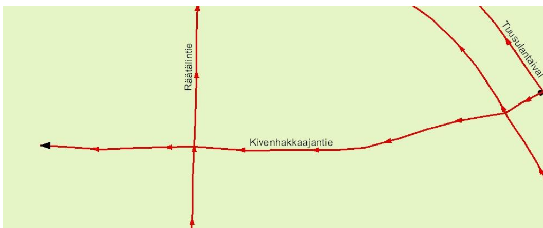
Bild 3. En referenskedja är bildad av alla vägelement för Kivenhakkaajantie.
